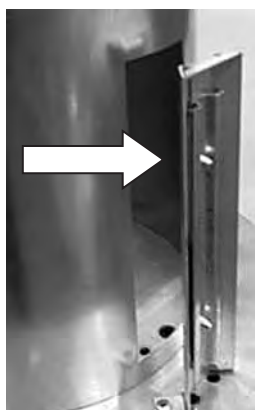
Kuva 1. Tarkista että lämpösuojan aukko oikealla kohdalla.
