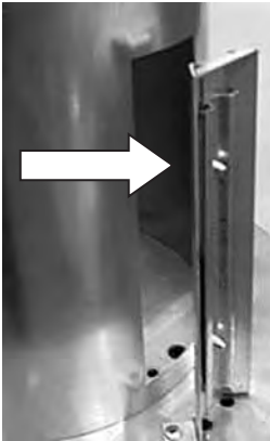
Kuva 1. Tarkista että lämpösuojan aukko oikealla kohdalla.
